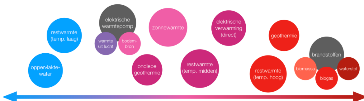
Figuur 2 Temperatuurniveau van diverse warmtebronnen van LT (links) naar HT (rechts)
